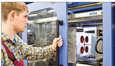
Термопластавтоматы для производства литых изделий
