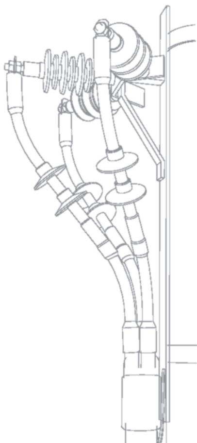
Кабельные муфты — это устройства, предназначенные для соединения кабелей в единую кабельную линию и их подключения к конечным электрическим установкам и воздушным линиям электропередач.
