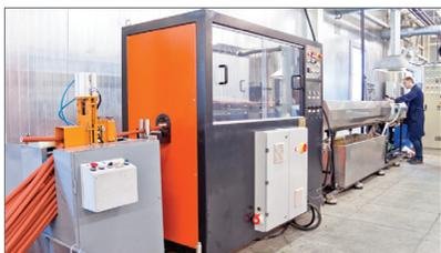
Линии для экструдирования термоусаживаемой трубки
