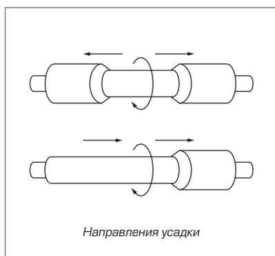
Для монтажа термоусадочных трубок рекомендовано использование высокотемпературного фена или портативных бутановых горелок. Пламя горелки следует отрегулировать таким образом, чтобы оно было мягким, с языками желтого цвета. Для монтажа толстостенных трубок и кожухов следует использовать пропановую горелку ПГ «КВТ»
